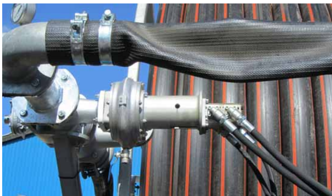
Billede 4. Vandturbine som drivmiddel til hydraulisk træk.
