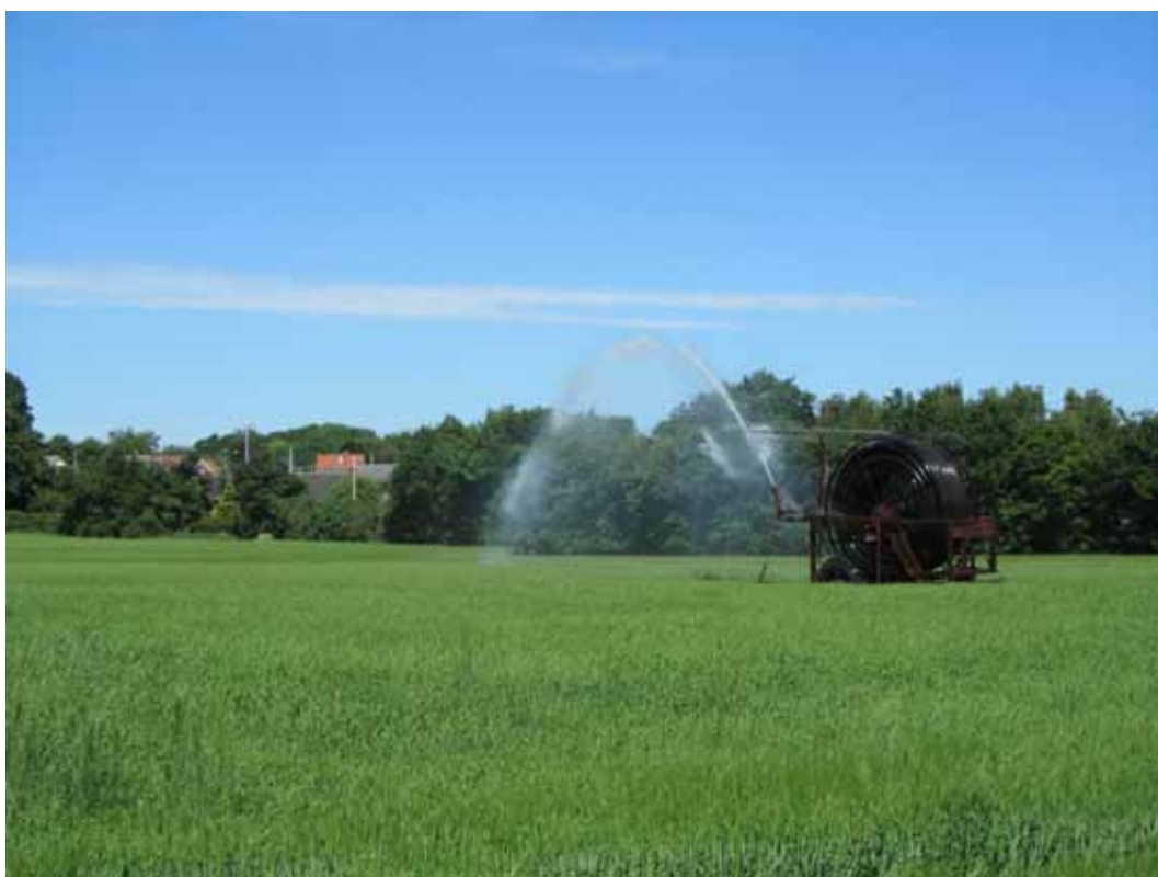
Billede 1. Kanonvanding er vindfølsom, men giver en relativt lav fordampning. Foto: Henning Sjørsløv Lyngvig.
